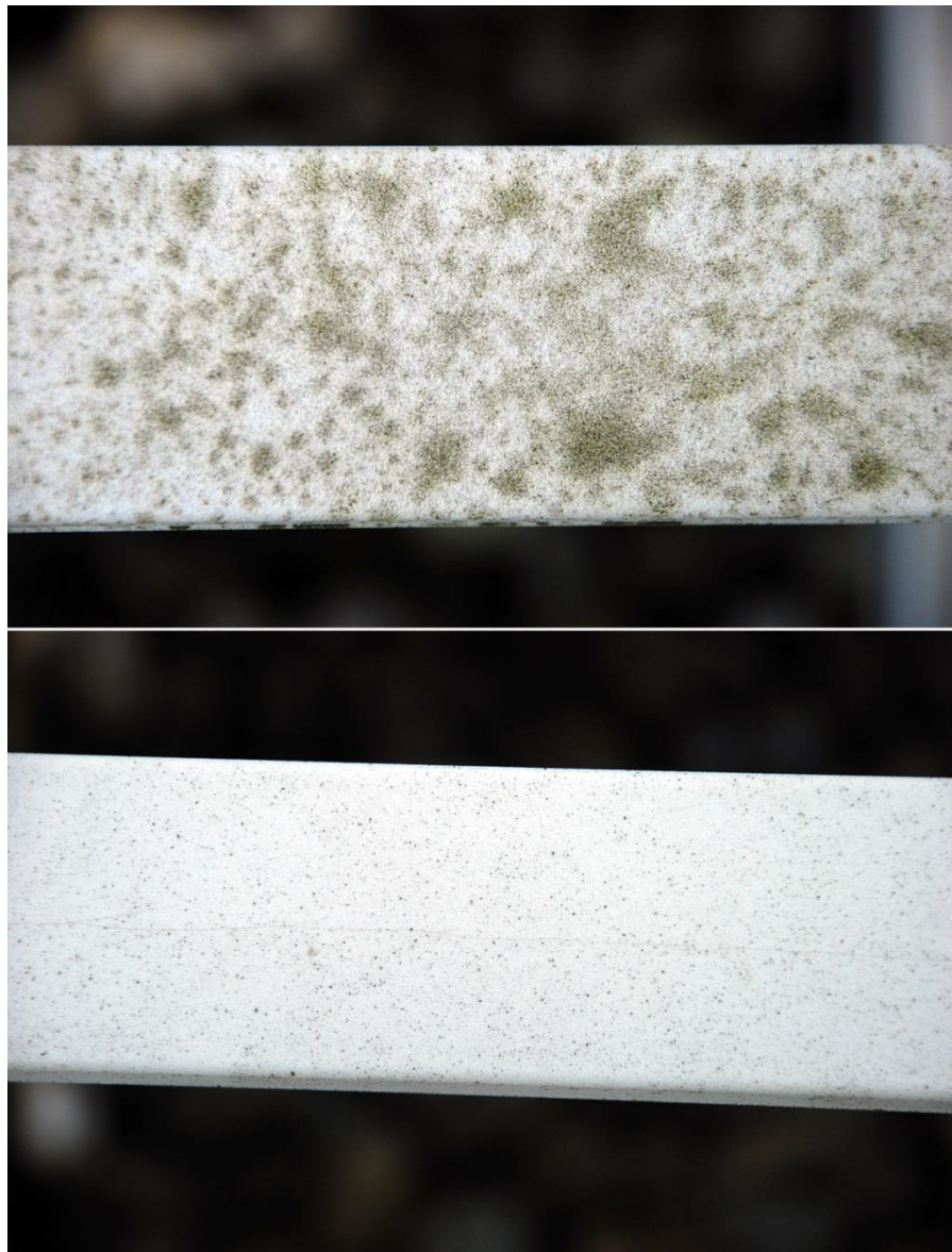
La superficie de abajo contiene moléculas de dióxido de titanio. Foto: © Fraunhofer IGB
